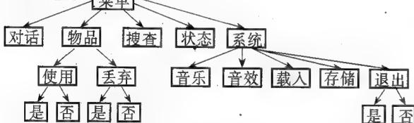
主程序是所有程序的中枢, 所有细节程序都由主程序连结, 都汇集于主程序, 换句话说, 主程序调用细节程序实现游戏目的, 细节程序则调用下一层程序。用下面的图示来理解:
